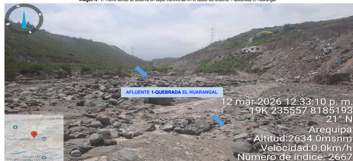
Imagen N° 2. Zona colmatada en el tramo, en donde se observa sedimentación de canto rodado (piedras) en el cauce del Afluente 1- quebrada El Huarangal.
