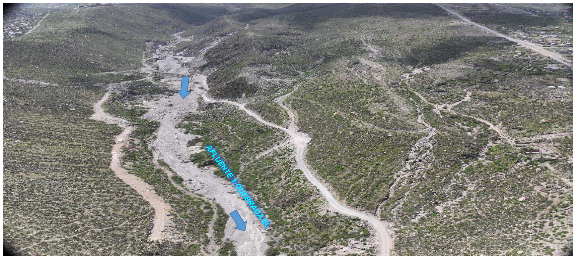
Imagen N° 3. Vista de planta tomada por el dron; Zona colmatada en el tramo, en donde se observa sedimentación en el cauce de la quebrada El Huarangal.
